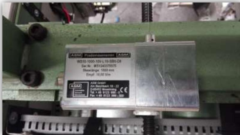
**Figura 62. Potenciómetro Eje X**
