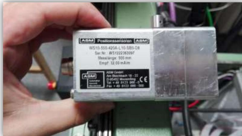
**Figura 63. Potenciómetro Eje Y**
