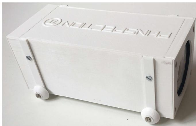
Ilustración 24. Ajuste de ruedas pequeñas a la carcasa (vista posterior)
