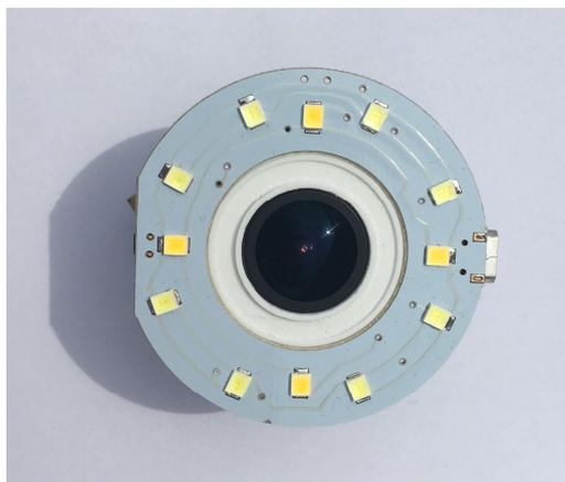
Ilustración 42. Conjunto corona de leds y lente
