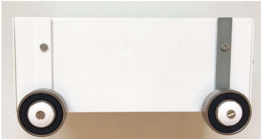
Ilustración 19. Lateral con acople para rodamientos
