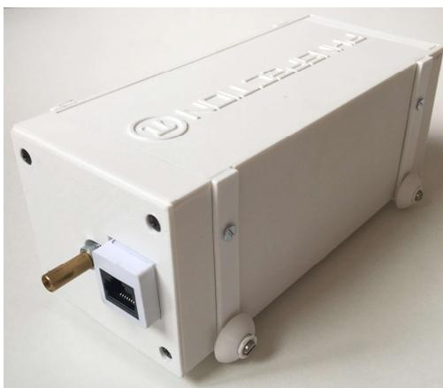
Ilustración 23. Ajuste de ruedas pequeñas a la carcasa (vista anterior)
