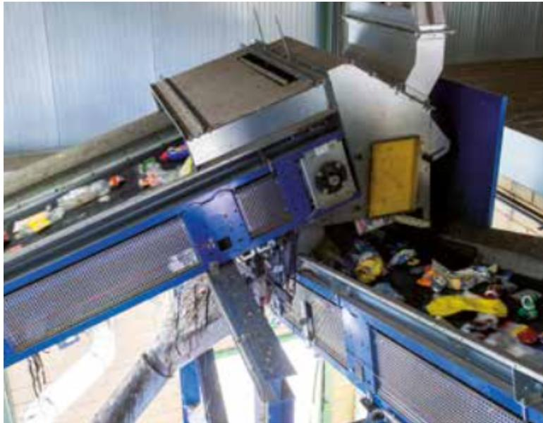
**Figura 12. Imagen de un separador neumático.**
