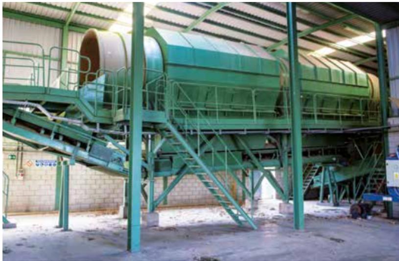
**Figura 11.** Imagen de un trómel de clasificación.
