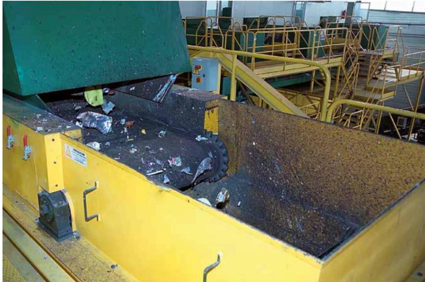
**Figura 14.** Imagen de un separador por corrientes de Foucault.
