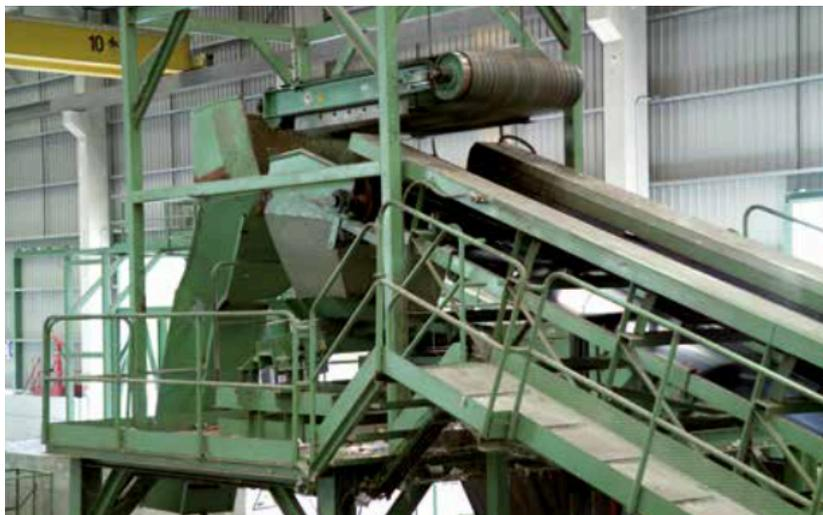
**Figura 13. Imagen de un separador magnético.**
