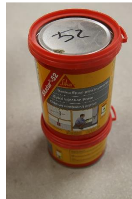
Figuras 71 y 72. Sellado de la superficie y resina empleada.
