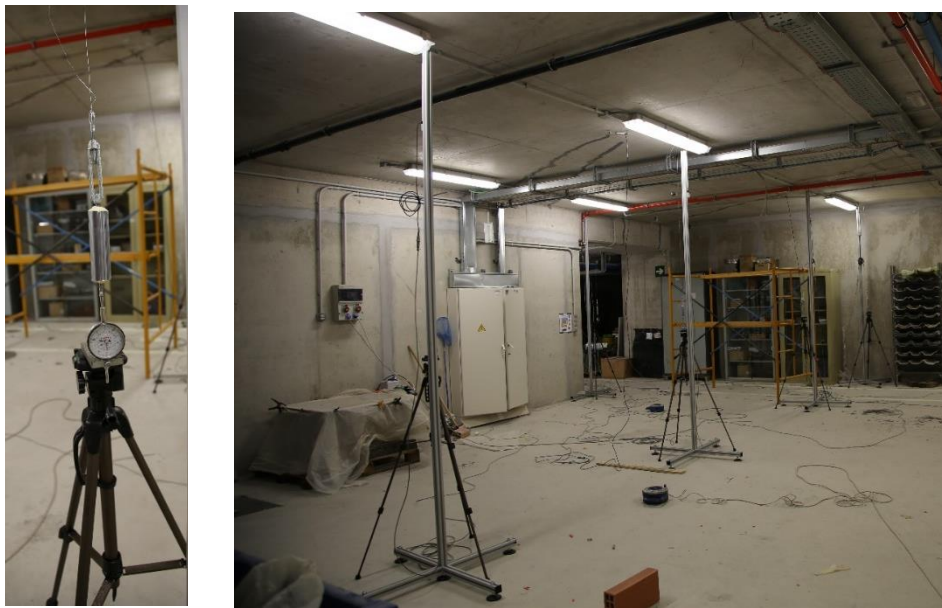
Figuras 83 y 84. Captador analógico y montaje de ambos captadores (analógico y digital)
