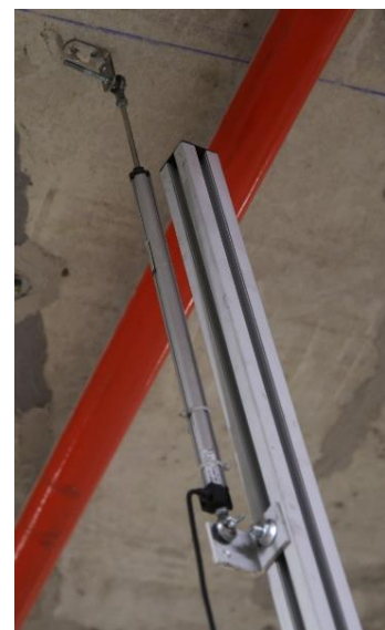
Figuras 76, 77 y 78. Montaje del captador digital de desplazamiento.
