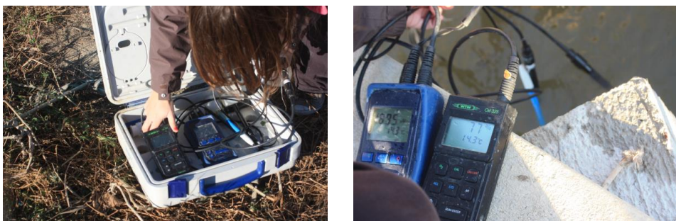
Figura 5-5: Imágenes del Multi 340i (WTW) y de la toma in situ de los parámetros físico-químicos del agua.
