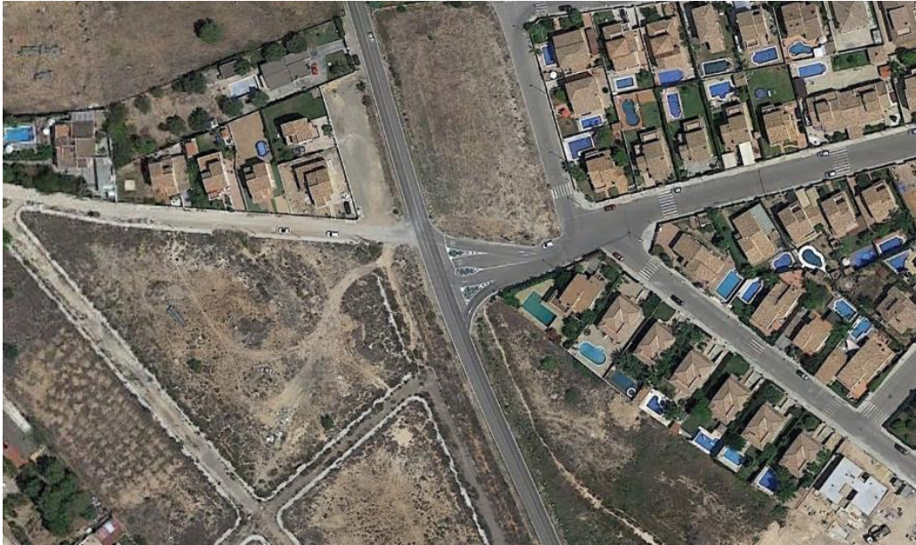
Imagen 22. Intersección canalizada en el PK 2+700. Vista aérea
