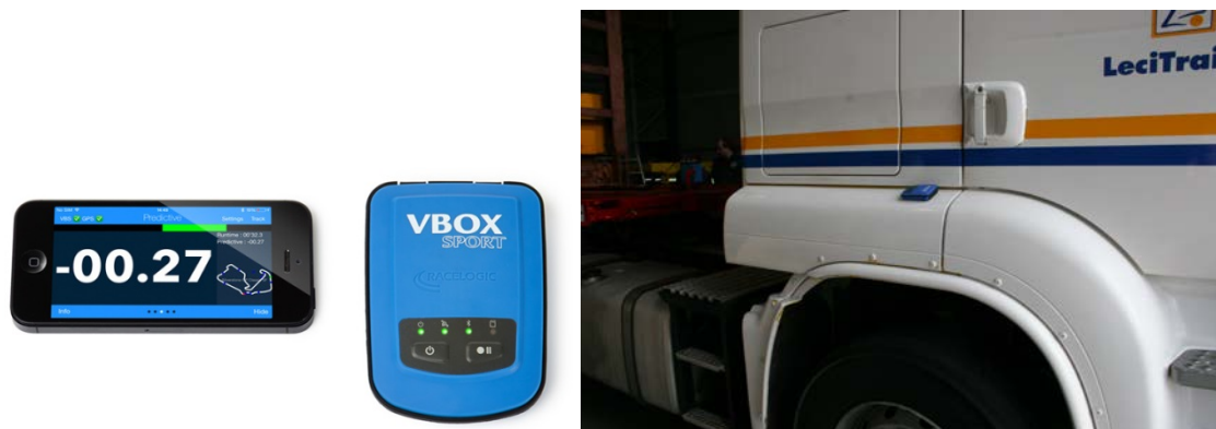
Fig. 3 Receptor GNSS de bajo coste empleado (VBOX Sport)
