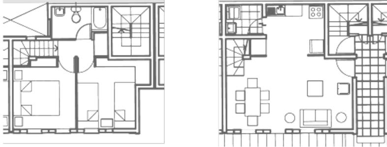
Fig. 5 Planta de una de las viviendas de dos niveles, el primero con las áreas sociales y el segundo con los dormitorios.
