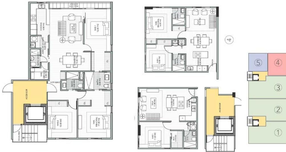
Fig. 10 Plantas tipo de la torre de apartamentos T40. El modelo de 115 m<sup>2</sup> se repite tres veces por nivel y un salón-comedor, cocina, área de lavado, un balcón a la calle, tres dormitorios y tres cuartos de baño. El segundo tipo, de 65 m<sup>2</sup>, tiene dos dormitorios, dos cuartos de baños, salón y cocina. La otra planta es un estudio de 50 m<sup>2</sup> con habitación, baño, salón-comedor y cocina.
