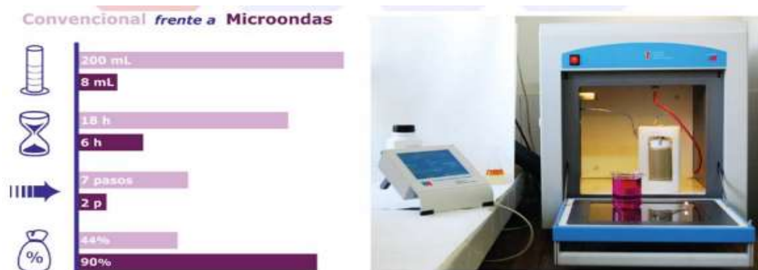
Figura 2. Comparativa de método convencional frente a método con horno microondas.
