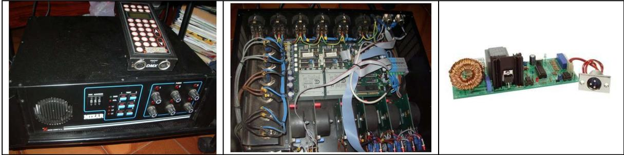
Figura 39 Dimmer: exterior, interior y un solo canal.
