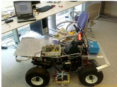
Figura 41 El vehículo quad con los actuadores montados y en fase de experimentación.
