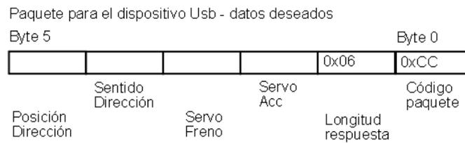
**Figura 44 Disposición de los datos en el vector de bytes**
