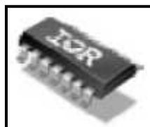
**Figura 5 Encapsulado SOIC.**
