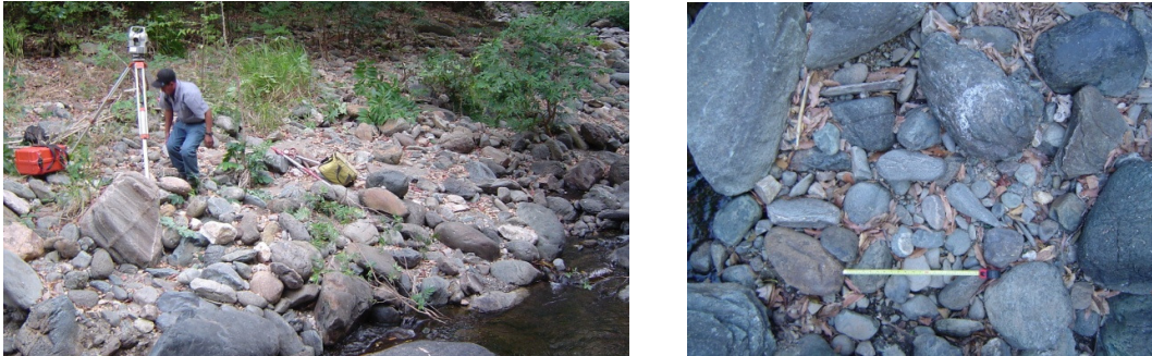
Figura 7.24. (i) Trabajo de levantamiento de información topográfica con Estación total en el transecto 2 del río Uyús. (d) Vista del material del lecho del transecto 3 del río Uyús y escala de referencia de 0.5 m para estimar su tamaño promedio. Fotos: M. Morales (2006).
