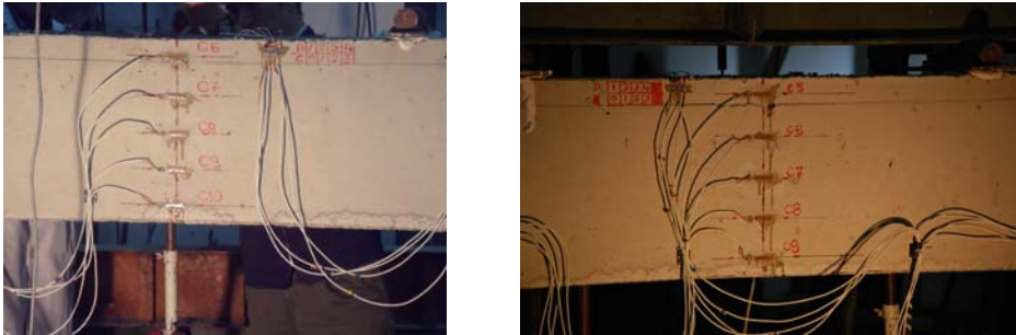
Figura 84. Situación de galgas de medición. a) Viga 1. b) Viga 2.
