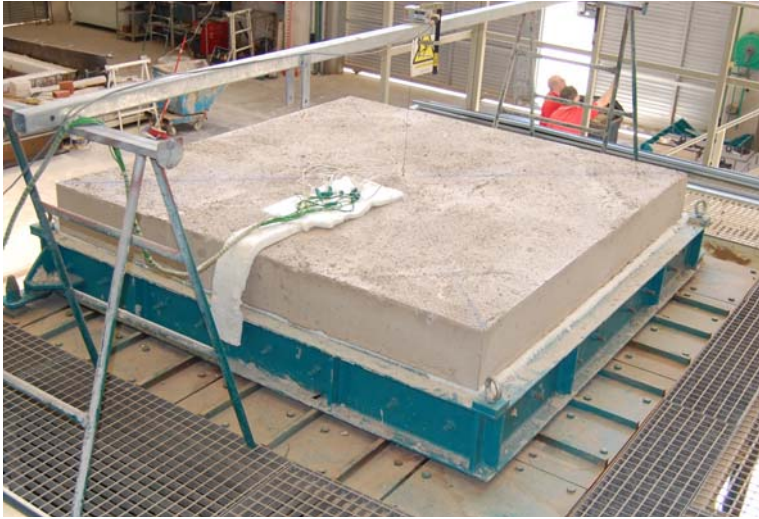
Figura 137. Montaje de la losa sobre el horno
