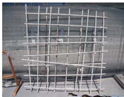
Figura 147. Armadura de la losa tras el ensayo a fuego
