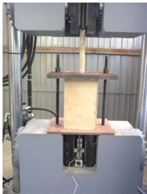
Figura 35. Dispositivo para la medición del deslizamiento
