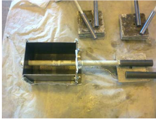
Figura 33. Probeta, encofrado cubo de hormigón
