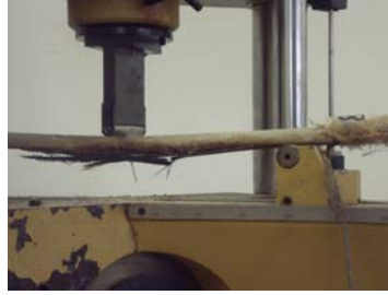
Figura 151. Ensayo a flexión. Pilar 3
