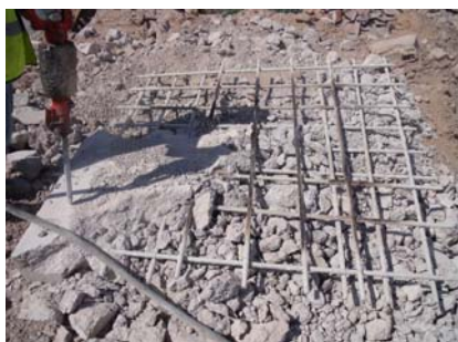
Figura 147. Armadura de la losa tras el ensayo a fuego
