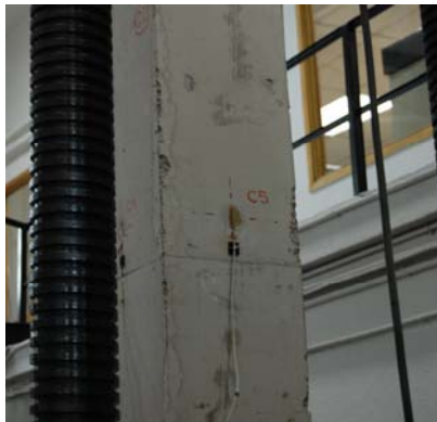
Figura 105. Disposición de las galgas las caras de hormigón del pilar
