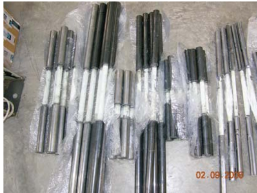
Figura 19. Probetas de GFRP para tracción.
