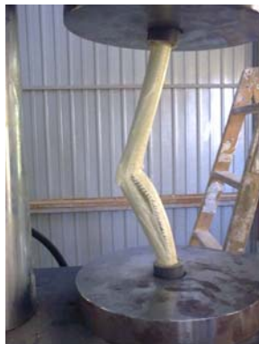
Figura 28. Probeta de GFRP ensayada a compresión.
