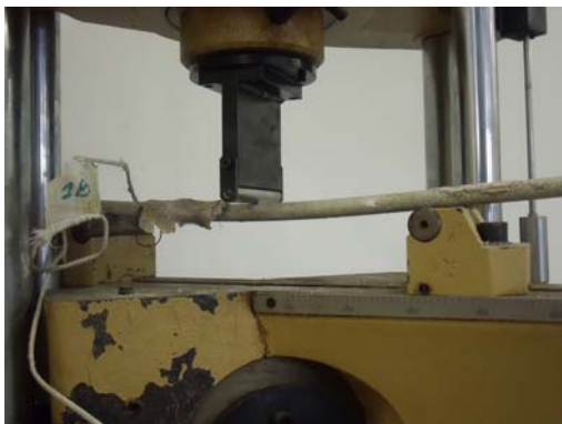
Figura 146. Ensayo a flexión tras la carga de fuego
