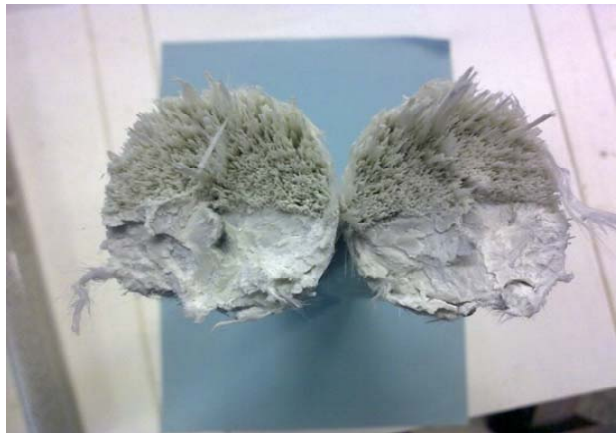
Figura 77. Ensayo a flexión. Fibras comprimidas y traccionadas.
