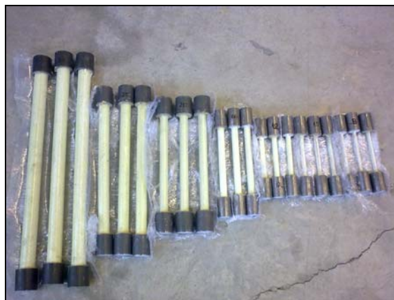
Figura 23. Probetas de GFRP para el ensayo a compresión
