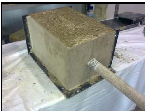
Figura 30. Etapa desencofrado probetas
