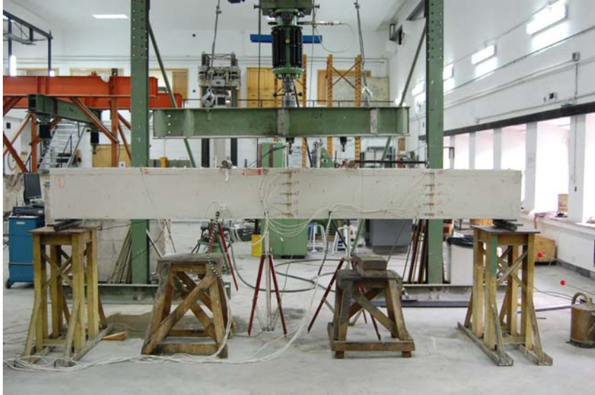
Figura 86. Ensayo a Flexión. Situación real.
