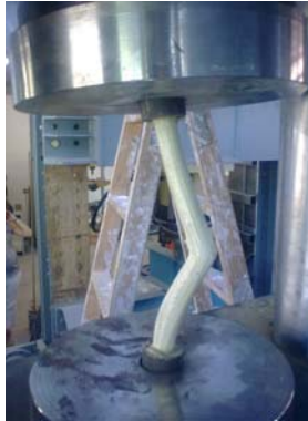
Figura 26. Ensayo a compresión, juego de platos
