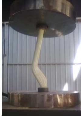
Figura 17. Rotura a compresión de una barra RTHp©
