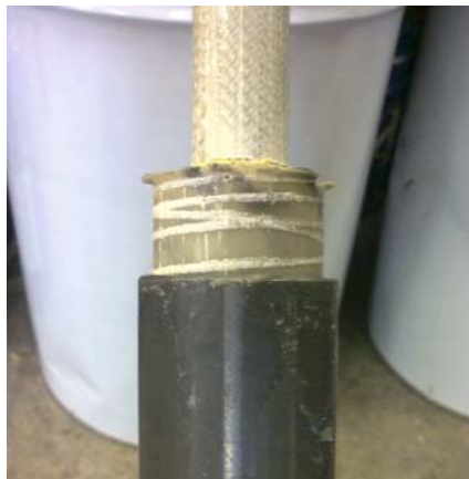
Figura 45. Deslizamiento en la probeta de ensayo con muleteado mínimo
