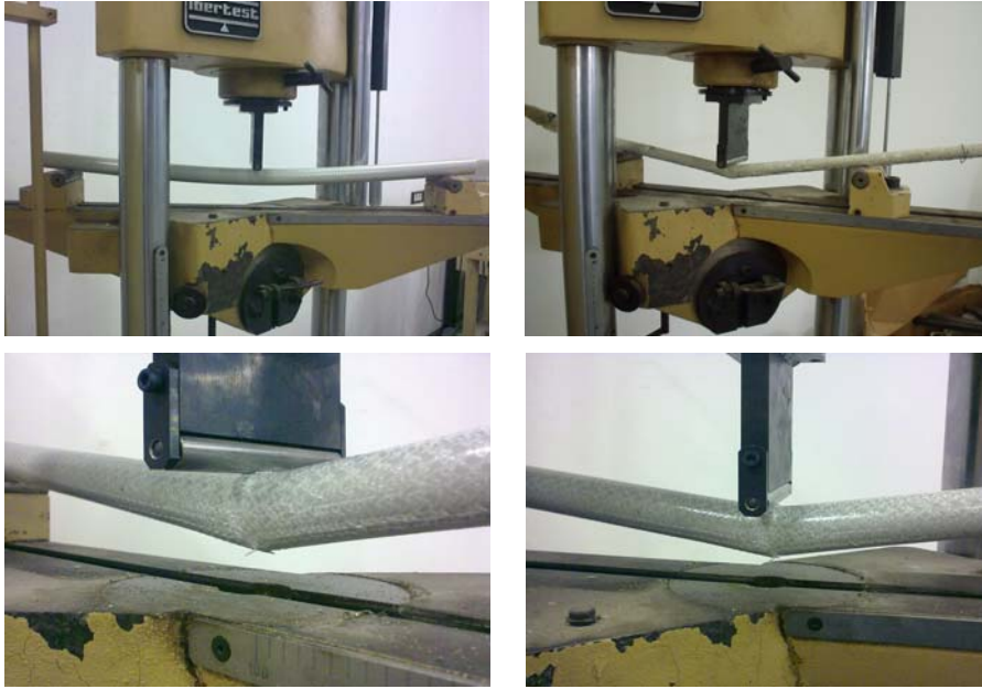
Figura 76. Ensayo a flexión para determinar la resistencia a tracción
