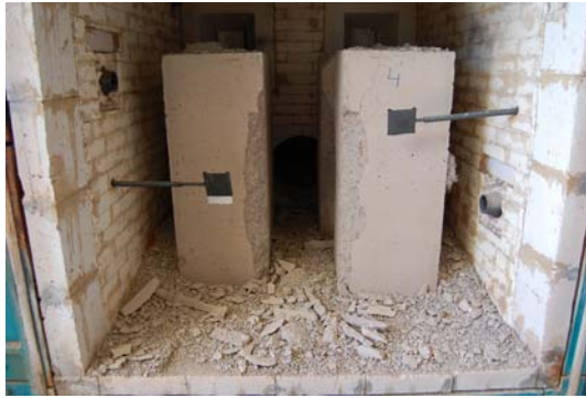
Figura 148. Ensayo a fuego. Pilares
