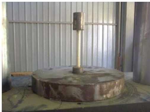
Figura 25. Plato para ensayo a compresión
