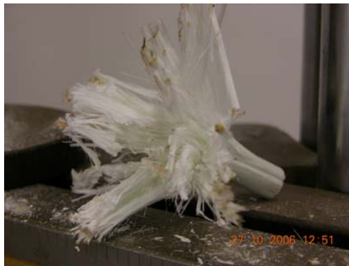
Figura 16. Rotura a compresión de una barra GFRP
