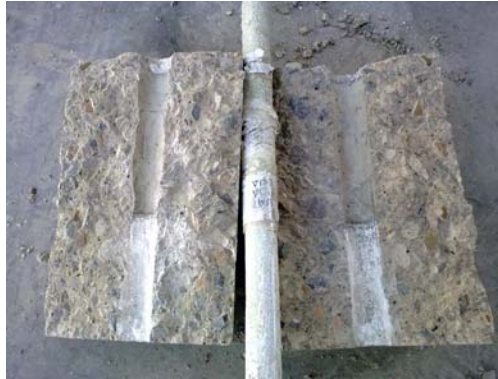
Figura 56. Probeta ensayada a adherencia
