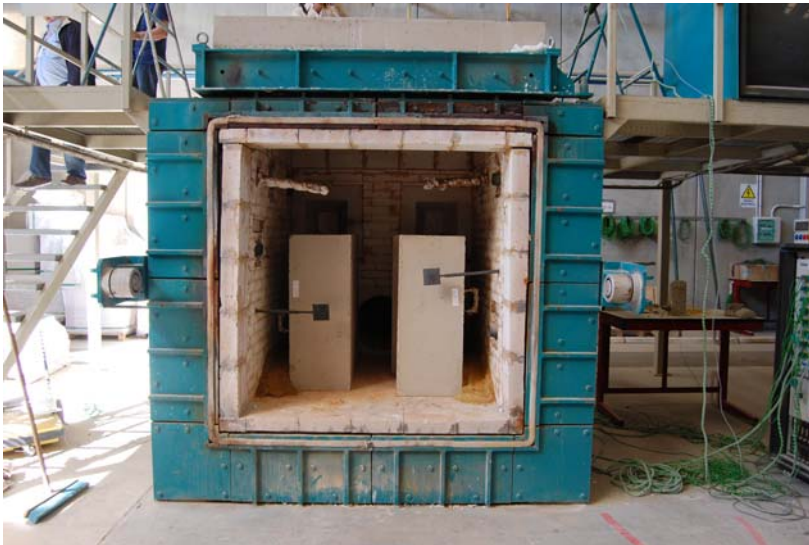
Figura 136. Ensayo a fuego. Horno y muestras situadas en el mismo
