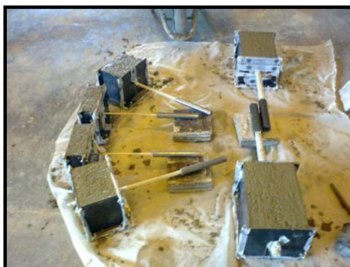
Figura 29. Proceso hormigonado y preparación de probetas para adherencia.
