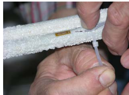
Figura 81. Detalle pegado de galgas en la armadura de las vigas
