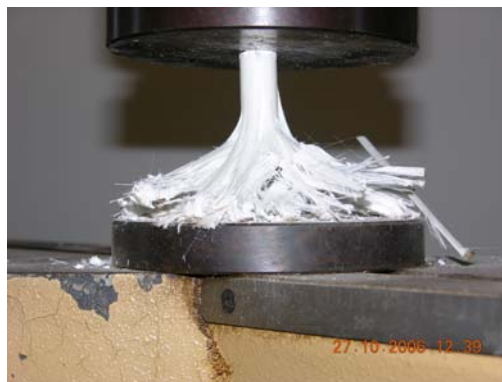
Figura 13. Barras GFRP a compresión
