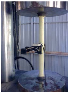
Figura 27. Extensómetro, ensayo a compresión.
