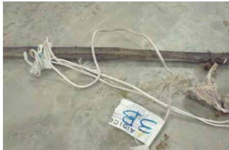
Figura 153. Redondo RTHp tras el ensayo a fuego. Pilar 1
