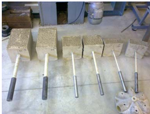
Figura 34. Forma de la probeta, barra de GFRP embebida
