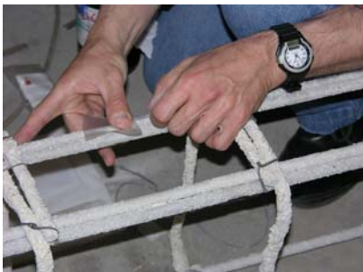
Figura 81. Detalle pegado de galgas en la armadura de las vigas
