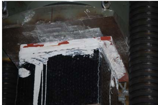
Figura 103. Excentricidad aplicación carga en el pilar
