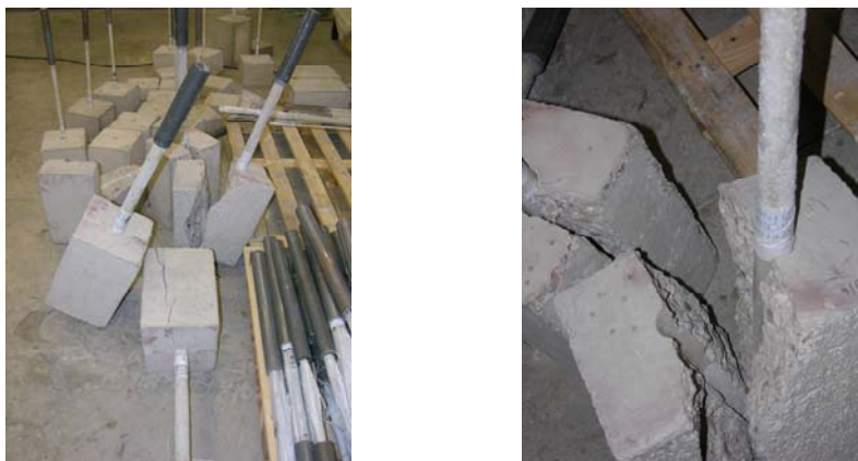
Figura 53. Probetas ensayadas a adherencia
