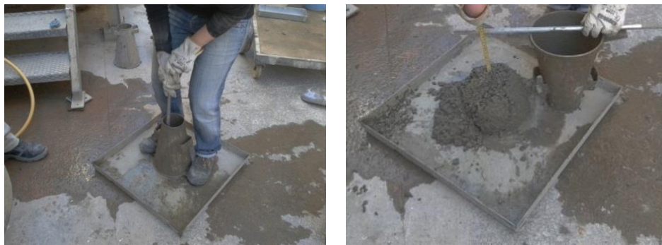
Fig. 3-27 - Slump test following UNE EN 12350-2:2009.
