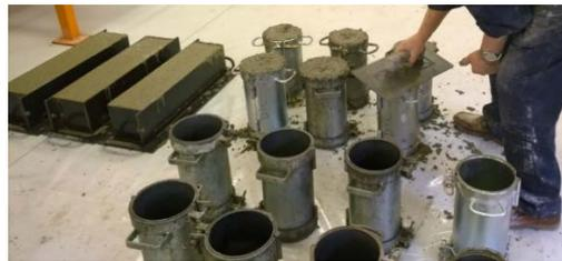
Imagen 9 Fabricación de probetas de hormigón.
