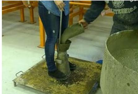
Imagen 10 Ensayo de asentamiento en el cono de Abrams
