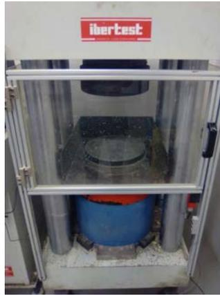
Imagen 12 Máquina de compresión IBER TEST
