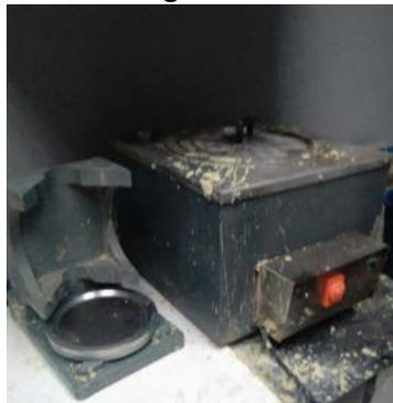
Imagen 11 Molde y horno para refrentado con azufre
