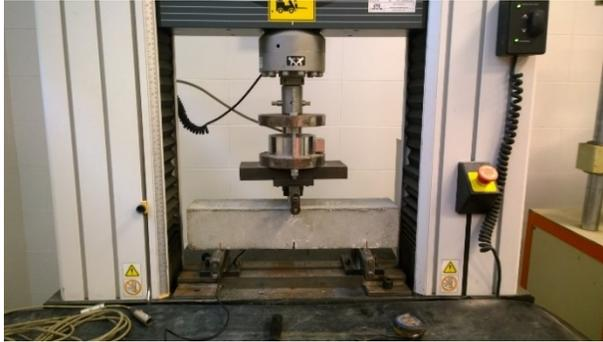
Imagen 15 Montaje ensayo de flexión tracción INSTRON
