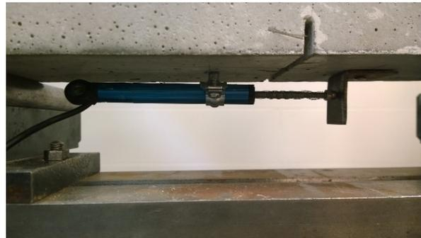
Imagen 13 Posición deformímetro y entalla en las vigas prismáticas para ensayo de flexo tracción.
