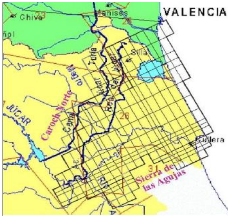
Figura 12. Discretización realizada en el modelo Modflow para el acuífero de la Plana Sur.
