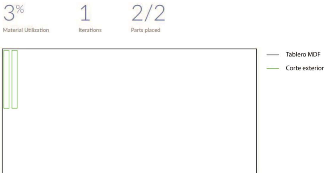
8 Posicionamiento de 2 LRC870 en espesor 25 mm
