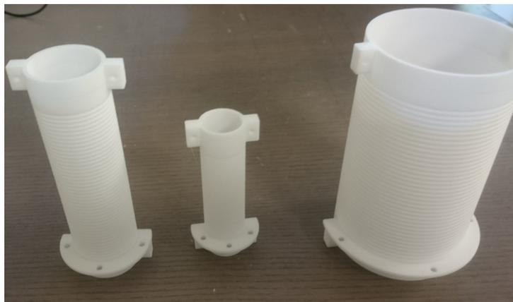
**Figura 5.2:** Soportes de pruebas de distintos tamaños, fabricados a partir del diseño presentado en este trabajo
