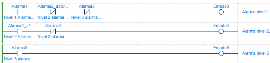
Ilustración 22. Ejemplo de la programación para la activación de estados
