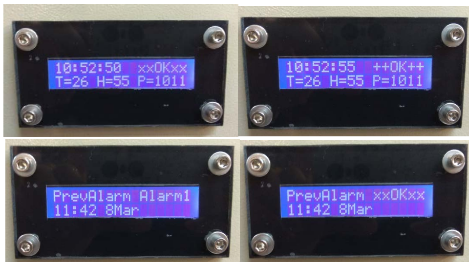
Ilustración 31: Funcionamiento de la pantalla LCD
