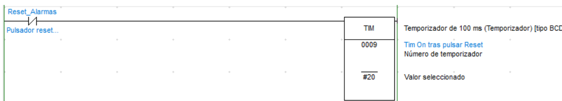
Ilustración 24. Ejemplo de la programación de temporizadores especiales
