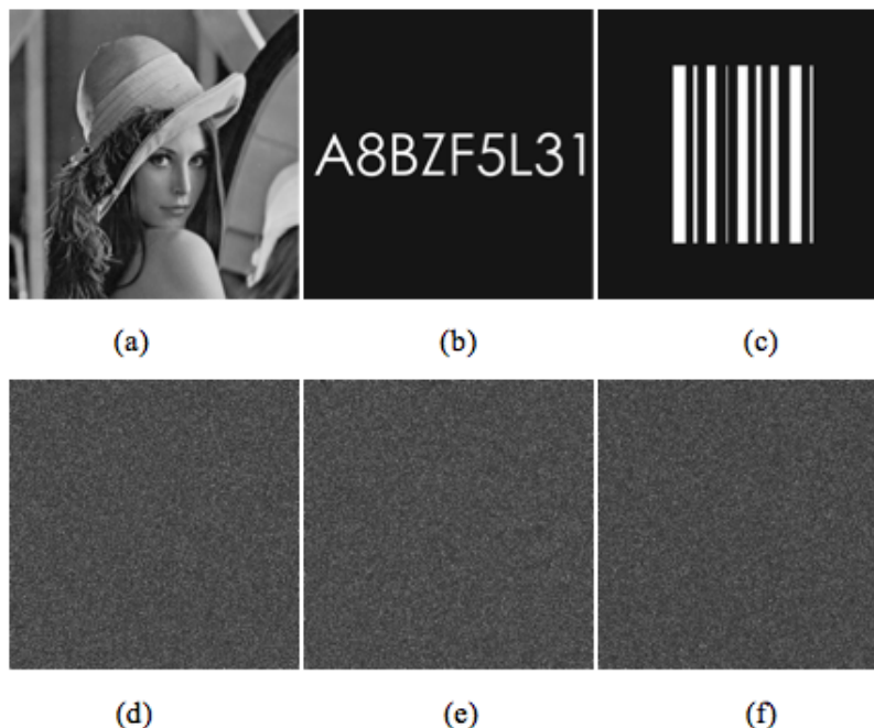
Figura 8: (a), (b) y (c) objetos recuperados empleando las llaves correctas. Descriptación con llaves generadas con el mismo intervalo [a, b] y los mismos valores de los parámetros \alpha, n, N y r para cada caso, pero con un valor de \omega igual a: (d) 4, (e) 5 y (f) 6, respectivamente.
