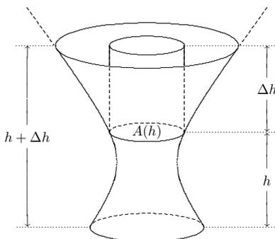
Figura 8: El área de la sección transversal varía continuamente
