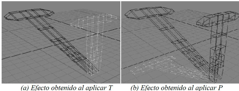
Figura 9: Efecto obtenido al aplicar las transformaciones  $T$  y  $P$  a un objeto.
