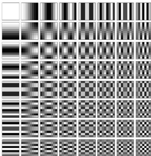
Figura 6: Base utilizada en la compresión de imágenes.
