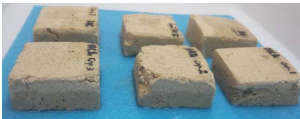
Figura 5. Transcurso del ensayo de absorción de agua por capilaridad sobre las probetas HC y HCA.
