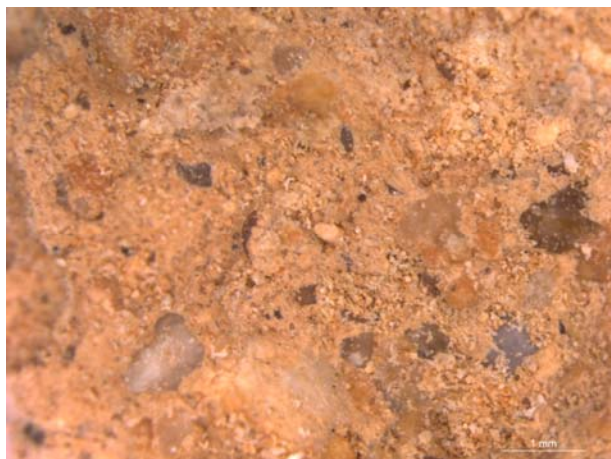
Figura 3. Vista al microscopio del mortero original con adiciones puzolánicas.
