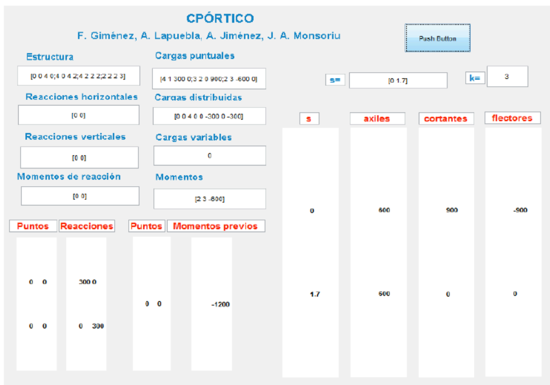
Figura 9: Aplicación cporti.m. Reacciones y valores de esfuerzos en las secciones s = 0 y s = 1.7 de la barra k = 3 de la estructura del Ejemplo 1.
