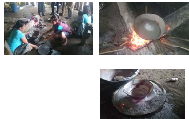
Grafica 3. (4A -4B- 4C). 4A. Procesos para la quema de la pieza 4B. Material refractario, ceniza. 4C proceso para el barnizado Copataza 2015, muestra (M17 CC.ER)
