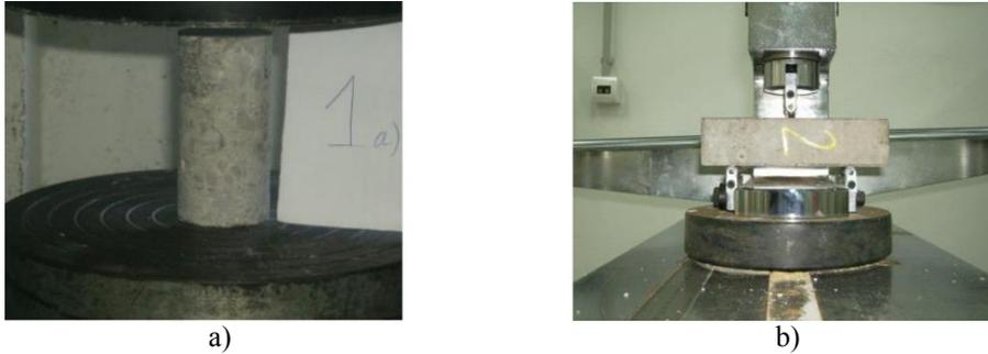
**Figura 1.** a) Muestra de probeta cilíndrica. b) Muestra de probeta prismática
