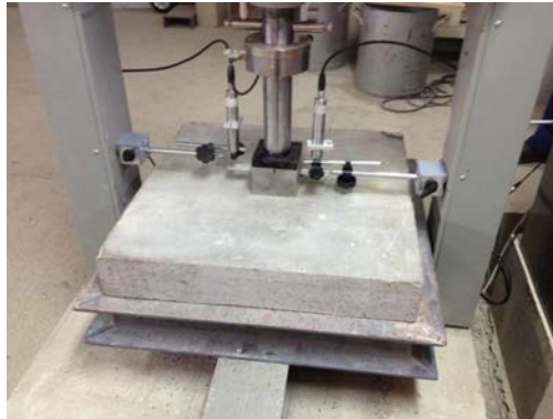
Figura 2. Configuración establecida por EFNARC para el ensayo de panel cuadrado.
