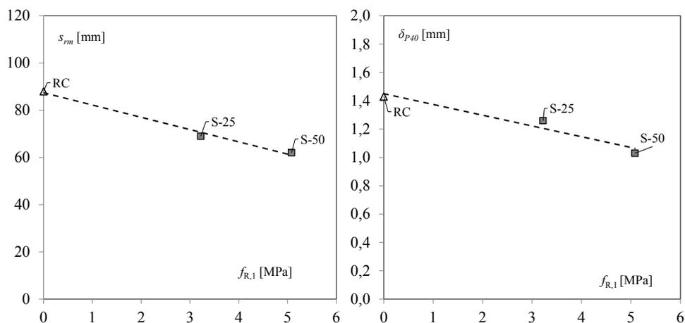
**Figura 6.** Efecto de la resistencia residual  $f_{R1}$  sobre el espaciamiento medio de fisuras en la etapa de fisuras estabilizadas (izquierda) y sobre la flecha post-fisuración (derecha), en vigas de hormigón armado preparadas con RC, S-25 y S-50.
