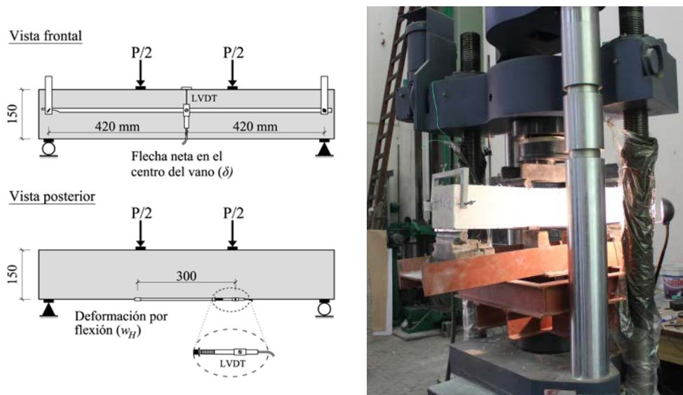
**Figura 3.** Ensayos sobre vigas de hormigón armado.
