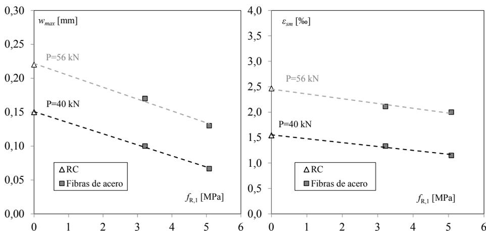
**Figura 5.** Efecto de la resistencia residual  $f_{R,I}$  sobre el ancho de fisura (izquierda) y sobre la extensibilidad de las vigas en el tercio medio (derecha) para diferentes niveles de carga, en vigas de hormigón armado preparadas con RC, S-25 y S-50.
