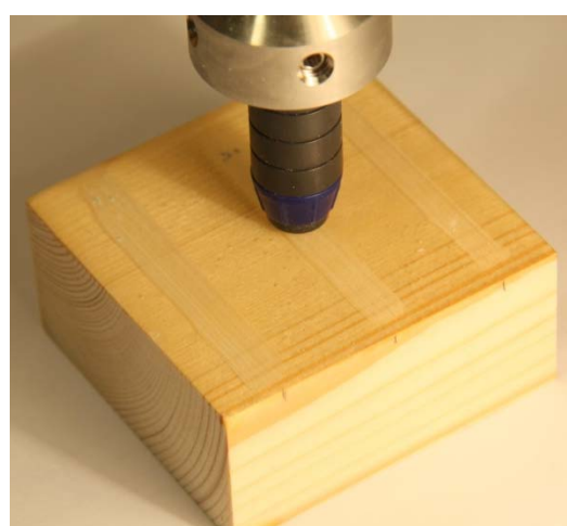
Figuras 7 y 8: Ensayo de abrasión con Linear Abraser a diferentes ciclos
