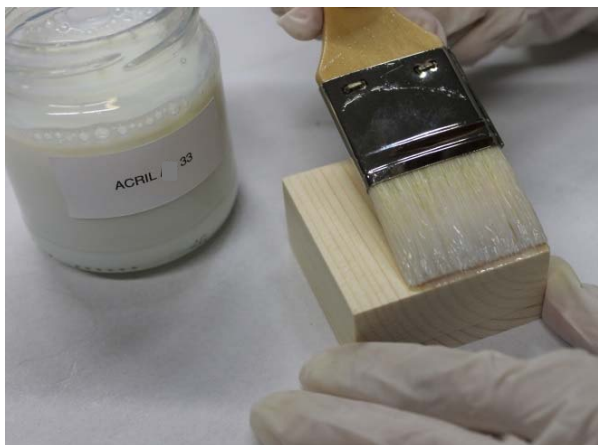
Figura 5: Aplicación de los diferentes adhesivos con brocha
