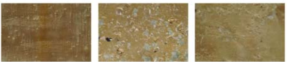
Microfotografía probeta PB/A, 80x, sometida a 5-15-22 ciclos/min
