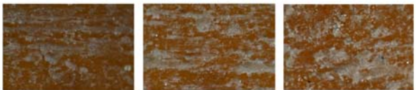
Microfotografía probeta TIT/A, 80x, sometida a 10-20-30 ciclos/min
