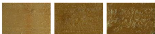
Microfotografía probeta EPO/A, 80x, sometida a 10-30-60 ciclos/min
