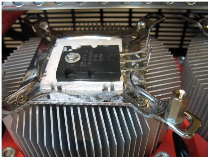
Figura 53: Detalle del transistor de potencia junto con el disipador
