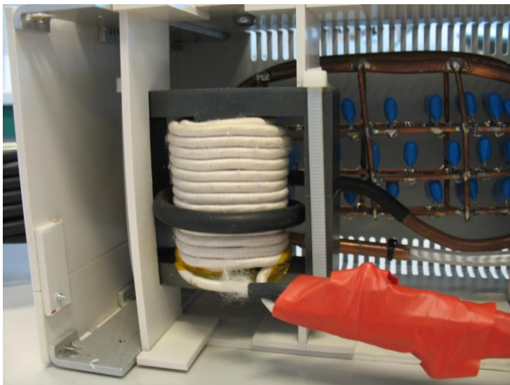
Figura 69: Detalle del transformador de potencia
