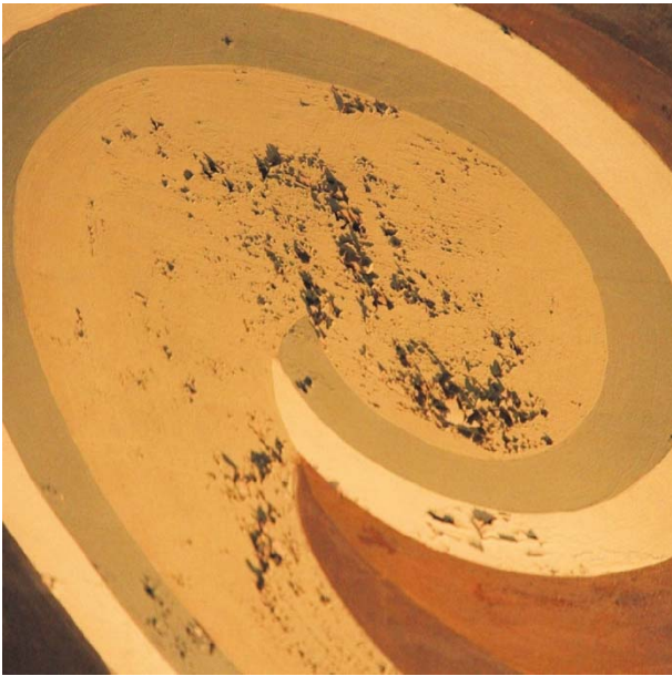
Figura 5. Descohesió de la pel·lícula pictòrica en forma de escames.
