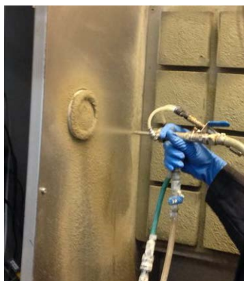
Figura 1. Proyección mediante dispositivo MiniShot en los laboratorios de Sika en Zurich, Suiza.
