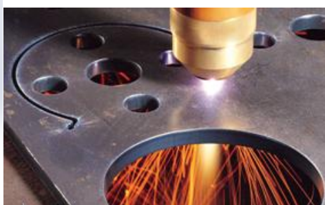
Imagen 67: Marcado corte Imagen 68: Corte por laser Imagen 69: Pieza cortada
