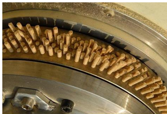
Imagen 13: Pellet en extrusión
