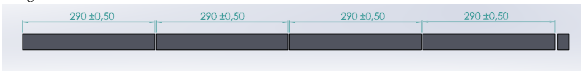
Imagen 102: Barra de aluminio dividida en cortes
