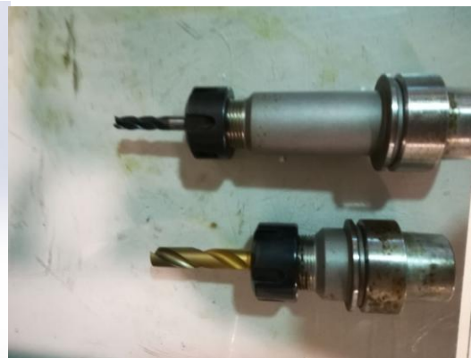
Imagen 64: Fresa Imagen 65: Cuerpo taladrado Imagen 66: Fresa y broca en su porta
