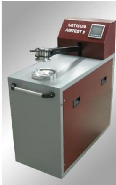
Figura 6. Aparato GK-6 de Gateslab para la evaluación de la permeabilidad al aire
