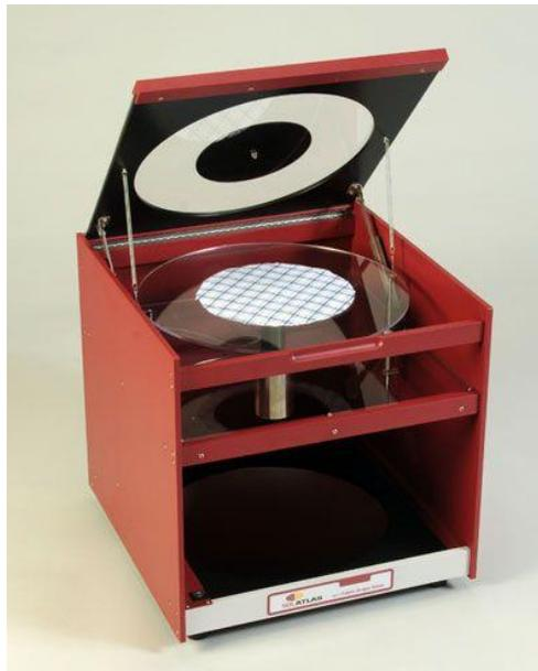
Figura 4. Aparato M213 de SDL Atlas para la evaluación de la caída
