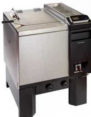
Figura 10. Máquina lavadora del tipo de laboratorio Gyrowash de James Heal
