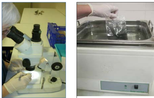
Figura 19. Trabajos bajo lupa binocular y baños en cubeta de ultrasonidos
