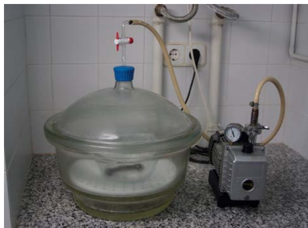
Figura 5. Protección con Paraloid B44 al 5% en impregnación al vacío.
