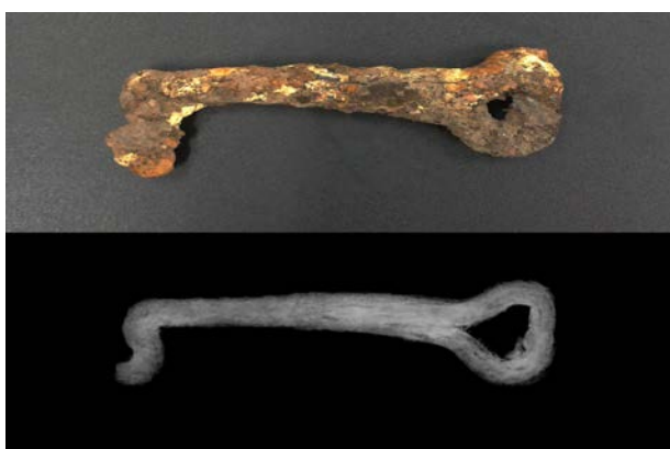
Figura 2. Estudio radiográfico de la llave.
