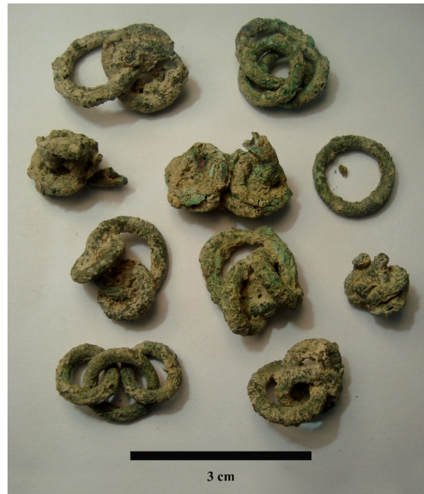
Figura 3. Muestra del estado inicial de algunas de las piezas de bronce a restaurar. Foto: A. Bertral.
