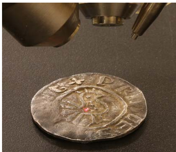
Figura 5. Cabezal del espectrómetro Artax800 XRF mostrando las sondas de irradiación, detección y láser utilizado para localizar el punto de análisis.. Fotografía de Piotr Frączek
