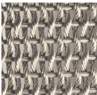
Imagen 4.3.9 Detalle malla metálica
