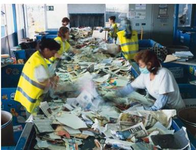
**62 El cribado, fundamental para el reciclaje, es un proceso labor-intensivo.**
