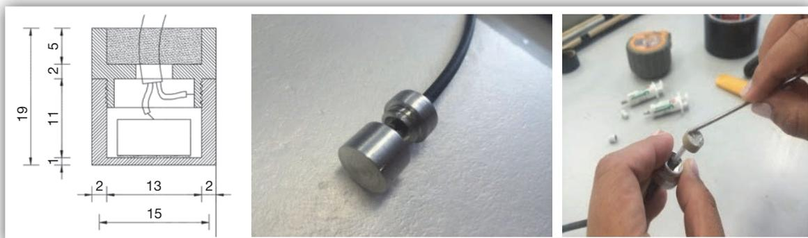
Figura 11. Diseño del encapsulado.
