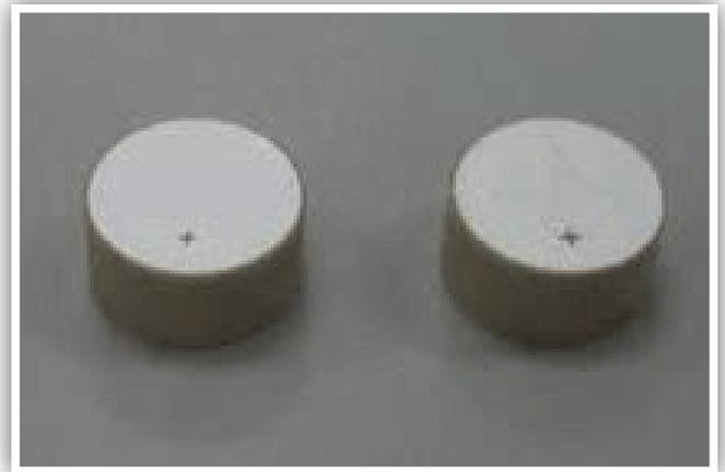
**Figura 5.** Cerámica PIC 255  $\varnothing 10$  mm y 5 mm.
