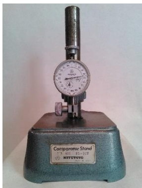
Figura 2. 12 Toma de medidas del espesor de membrana como reloj comparador.
