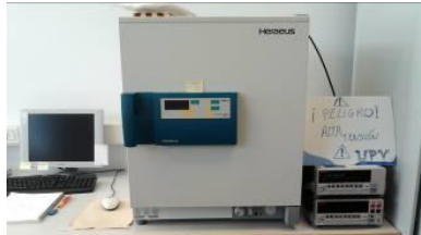
Figura 3. 13 Montaje para ensayos de despolarización isoterma. De izquierda a derecha: PC para el control y captura de datos, estufa y femtoamperímetro.
