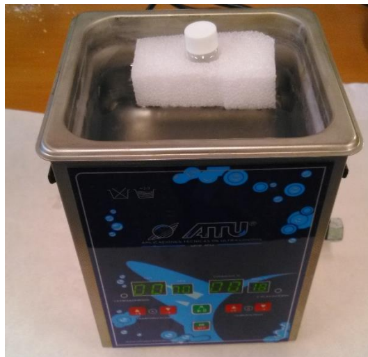
Figura 2. 9 Preparación de la suspensión de GO mediante ultrasonidos.
