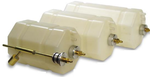
Figura 6. 24 Fotografías del depósito de combustible para la maqueta con detalle del sistema de cebado.
