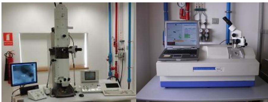
Figura 3. 2 TEM (izq.) y molino iónico (dcha.) que se usaron para el análisis en esta tesis.
