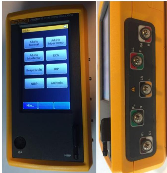
Figura 42. ProSim™ 4, Vital Signs Simulator de FLUKE Biomedical. Vista frontal, panel de control, vista lateral, electrodos que simulan las extremidades.
