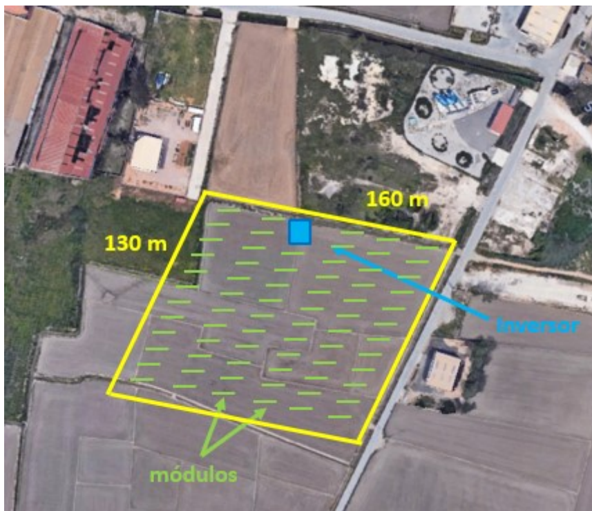
Figura 76. Croquis de a instalación solar fotovoltaica
