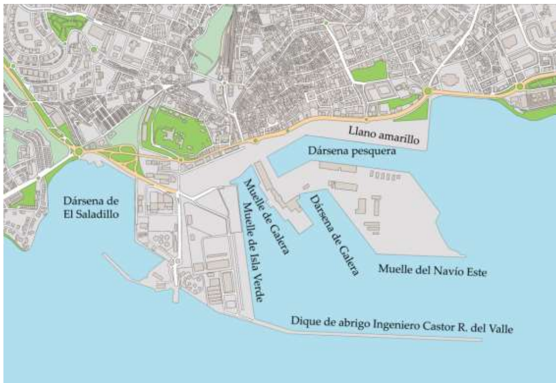
Figura 24 - Obras marítimas presentes en el puerto de Algeciras hasta 1985. Fuente: Diario Sur.
