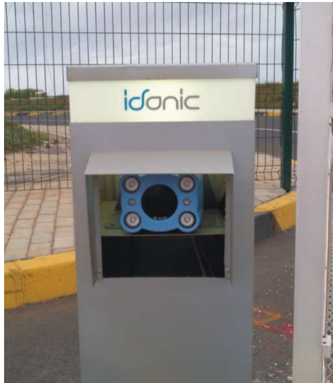
Figura 35 - Ejemplo de sistema OCR (Optical Character Recognition). Fuente: Idonic.
