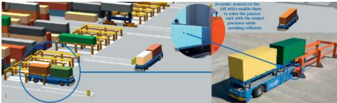
Figura 50 - Operativa de los AGV-Lift. Fuente: Gottwald Port Technology.
