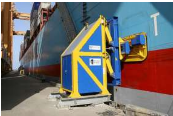
Figura 37 - Sistema de amarre automático de la empresa Cavotec. Fuente: Cavotec.
