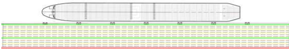
Figura 47 - Configuración de atraque 1: buque Malacamax. Fuente: elaboración propia.
