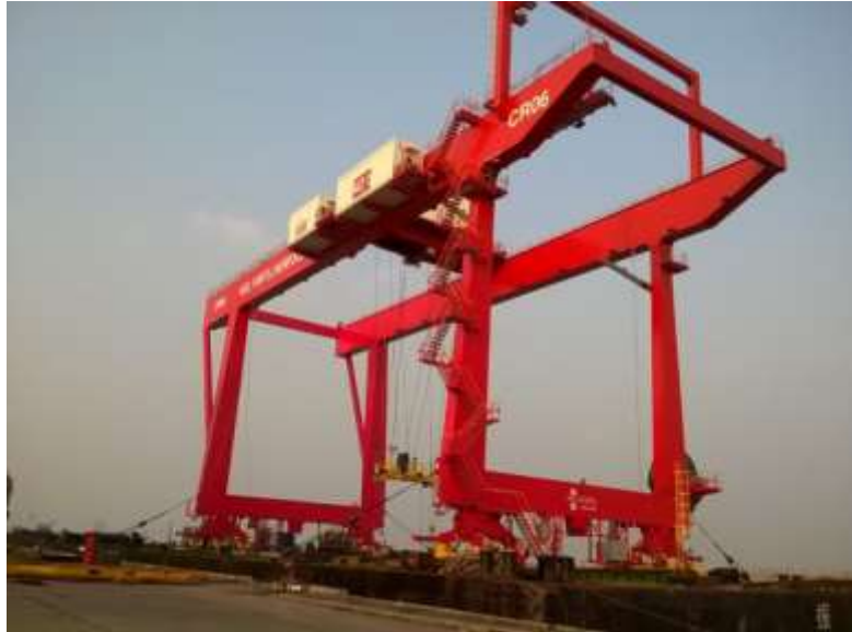
Figura 42 - C-RMG transportada a una terminal de contenedores china. Se puede observar que es para grandes apilados. Fuente: Peel Ports.
