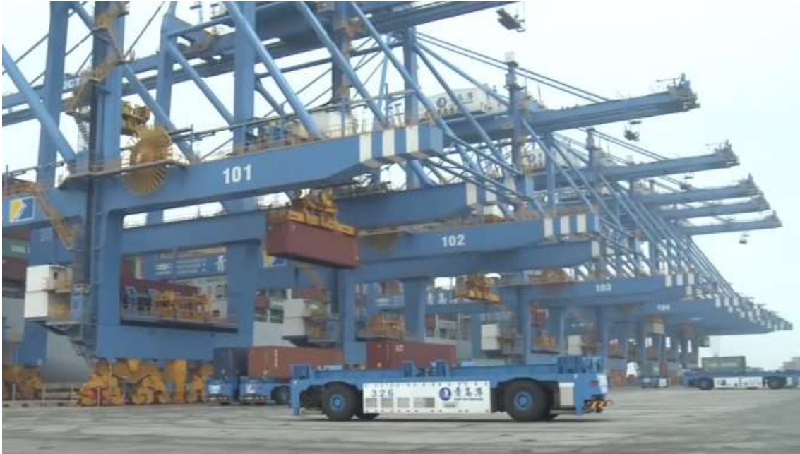
Figura 20 - Grúas STS de la terminal automatizada de Qingdao. Fuente: China News.
