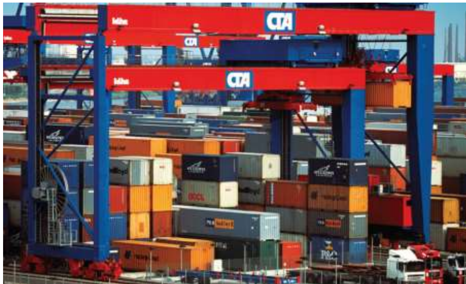
Figura 51 - Automated Stacking Cranes pasantes. Fuente: CTA Altenwerder terminal (Hamburg, Germany).
