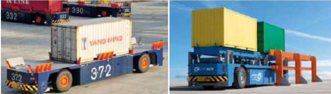
Figura 39 - Equipos de interconexión automatizados AGV (izquierda) y AGV-Lift (derecha). Fuente: Terex Gottwald.
