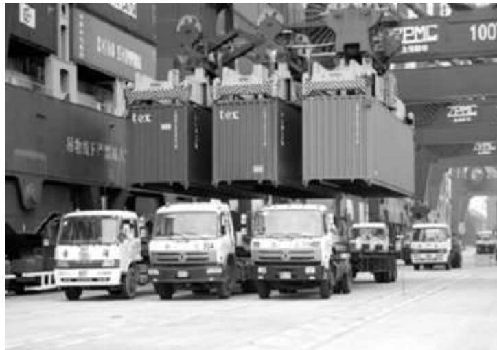
Figura 46 - Triple spreader con twin-lift. Fuente: Influencia de los sistemas de automatización aplicados en la gestión de nuevas terminales de contenedores.
