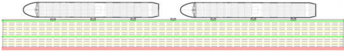
Figura 48 - Configuración de atraque 2: buques feeder. Fuente: elaboración propia.
