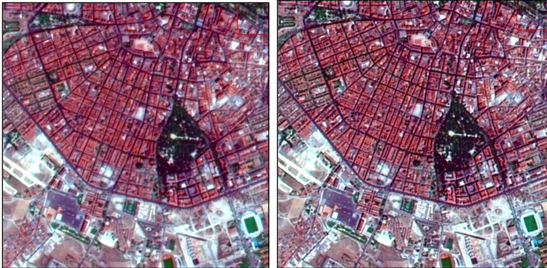
Figura 5.- Ejemplo de aplicación de un filtro High boost. Puede apreciarse el aumento aparente del detalle espacial (altas frecuencias) en la imagen filtrada (derecha).
