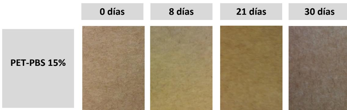
**Figura 117.** Desintegración de la mezcla de PET recaldado con un 15% de PBS en condiciones de compostaje según la norma UNE-EN ISO 20200.
