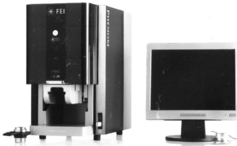
**Figura 43.** Microscopio electrónico de barrido PHENOM.
