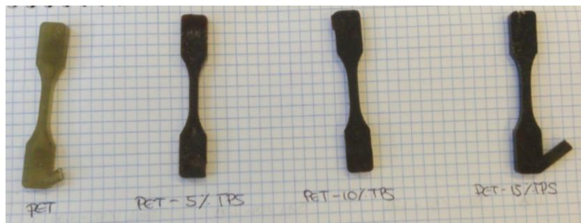
**Figura 105.** Probetas realizadas con PET reciclado con TPS a (5, 10 y 15) % wt
