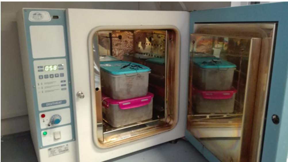
**Figura 46.** Estufa utilizada para los ensayos de biodegradación de las diferentes muestras.
