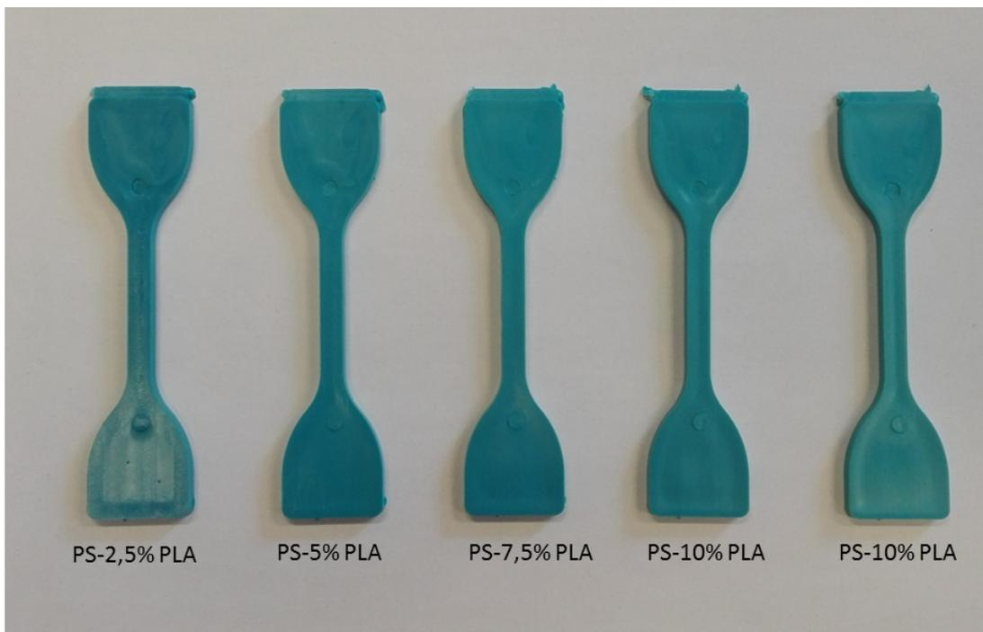
**Figura 33.** Mezclas de PS con diferentes porcentajes de PLA
