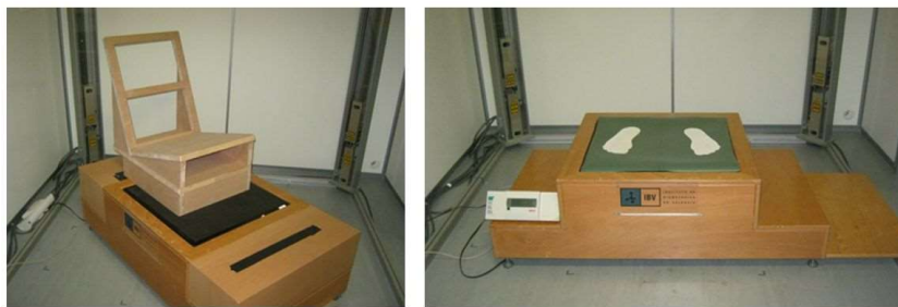
Figura 3. Izquierda: Orientación del asiento en la cabina de escaneado para adquirir la postura de conducción. Derecha: Orientación habitual del sujeto en la plataforma de escaneado
