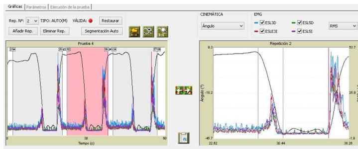
Figura 6. Segmentación automática de la prueba y gráficas de ángulo de FE lumbar y de 4 canales de EMGS
