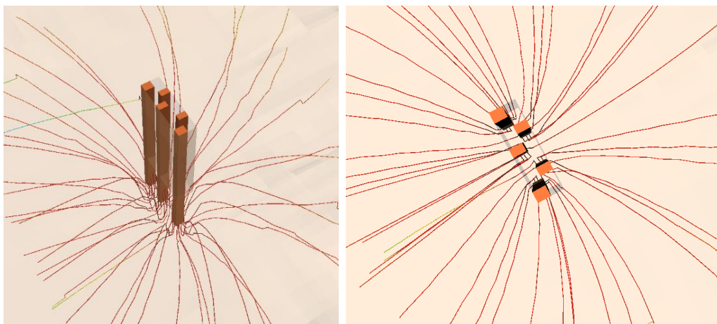
Figura 44. Vistas de la red de flujo advectiva. Fuente: Elaboración propia y postprocesado con ModelViewer (Hsieh, P. A. y Winston, R. B., 2002).
