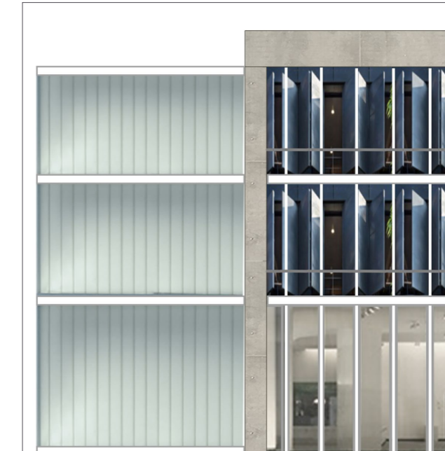
2. Hormigón con un tono cálido, volumen de servicio de u-glass, las líneas de forjado y los montantes metálicos lacados en blanco, carpinterías metálicas y mallorquinas de chapa perforada.
