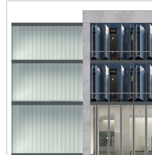
1. Hormigón in-situ gris, volumen de servicio de u-glass, líneas de forjado y montantes metálicos acero gris oscuro, carpinterías metálicas y mallorquinas de chapa perforada.
