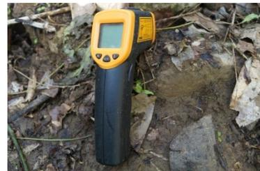
**Figura 16:** Termómetro láser para registrar la temperatura de la muestra de agua.
