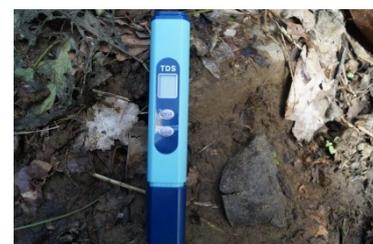
**Figura 18:** Instrumento para realizar mediciones de Sólidos Totales Disueltos.
