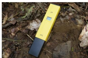
**Figura 17:** Instrumento para realizar mediciones de pH.
