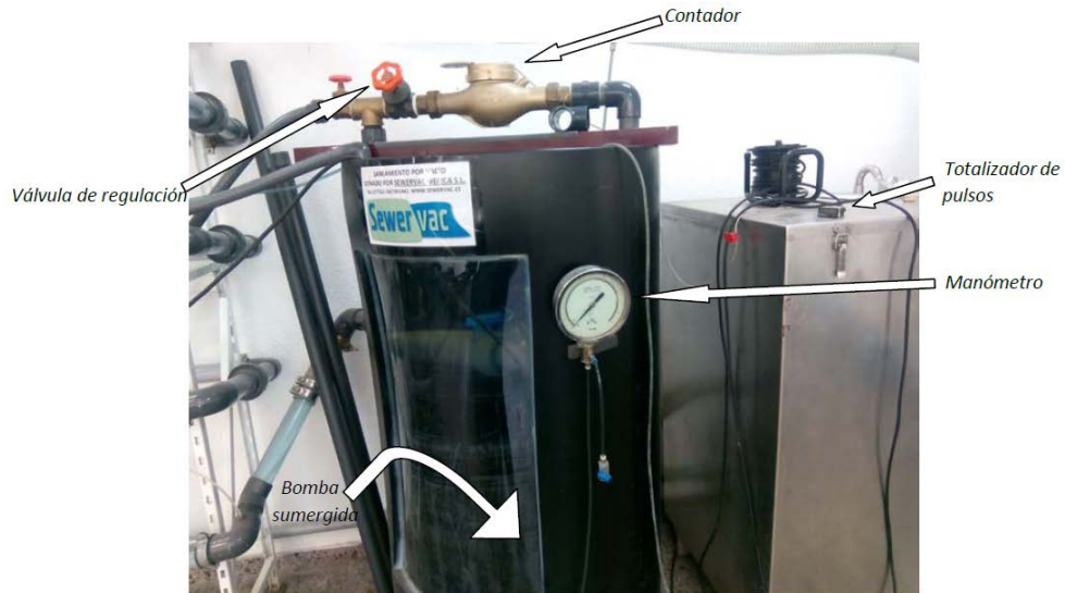
Fig. 3. Ejemplo de fotografía incluida en el apartado de descripción del banco de trabajo (Banco 2).
