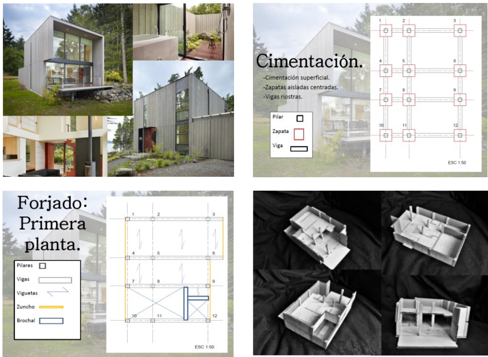
Fig. 2. Análisis de una vivienda: cimentación, estructura y maqueta Trabajo del curso 2015-16 realizado por C. Gutiérrez, V. Pérez, C. Di Lorenzo, M. A. Muntaner y P. Martínez.
